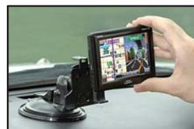
吸盤プレートの上でレバーを倒せばガッチリ固定!
