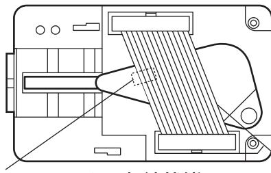
イモビ通信部品（左図 点線部分）がリボンケーブルに
