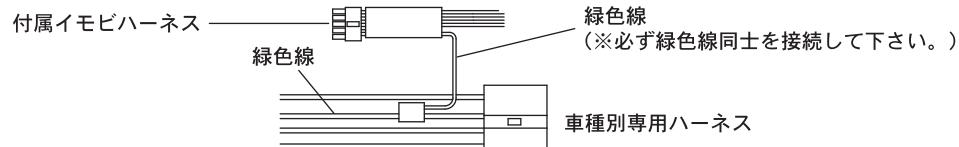
**7** 付属イモビハーネスの10Pコネクターをイモビアダプター本体に差し込みます。次に、付属のイモビハーネスの4Pコネクターをビータイムメインユニットの「イモビアダプター（OP）」のポートへ接続します。
