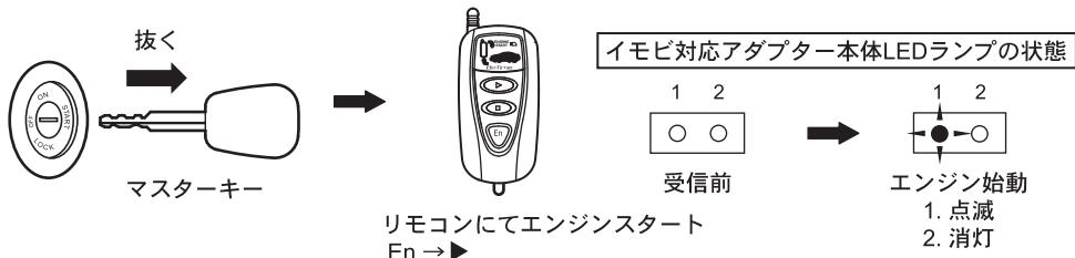
**10** 動作確認後、正常であればイモビアダプター本体を付属のインシュロック大又は付属の両面テープで車輌に固定します。
