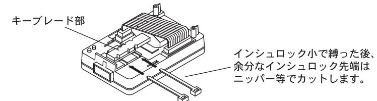
4 上フタを下図のように本体に取付けた後、付属のネジで締め付けます。
