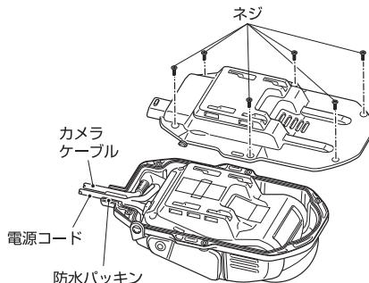
・注: 電源コードの収縮チューブを防水パッキンに挟み込まないように下図のように一周巻いて収縮チューブを避けて挟み込んでください。
