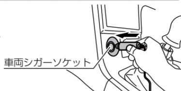
2. レーダー本体の USB 電源ジャックに付属の USB シガープラグコードを差し込みます。
