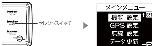
2. 【セレクトスイッチ】を短押してメニュー項目を選択し、【ネクストスイッチ】を短押して決定します。
