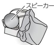
2. レーダー本体側面のカバーを開け、イヤホンジャックにヘルメットスピーカーのプラグを接続します。
