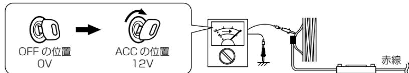
※ OFF の位置で電圧が 0V にならない車両はイグニッション電源へ接続してください。
