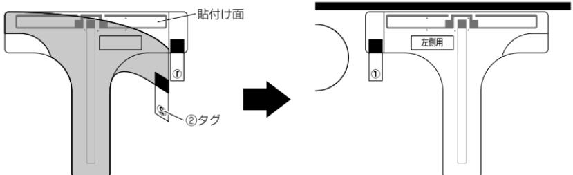
※ フィルムアンテナをこする際、ヘラなど固いものを使用しないでください。破損の原因となります。
