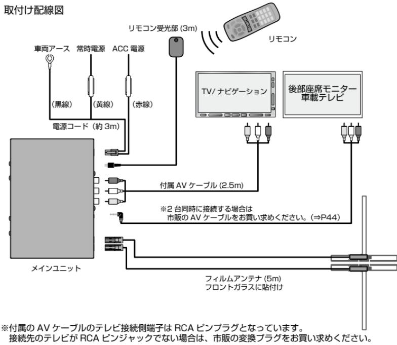
※付属のAVケーブルのテレビ接続側端子はRCAピンプラグとなっています。
