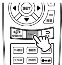
2) 検索が開始され、「スキャン中」の表示がされます。検索が終わると、受信したチャンネルを登録し、受信チャンネルの一覧を表示します。
