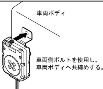
サイレン固定用ブラケットのみで取付けできない場合は付属のサイレン固定用補助ステーを使用し、車両に合わせて取付けを行ってください。
