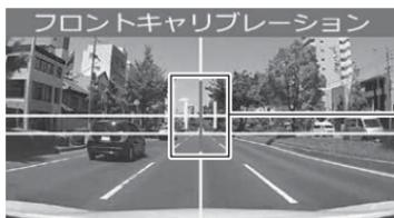
赤色の縦線が車線の中心に合うように【アップ】【ダウン】やフロントカメラの向きで調整する。
