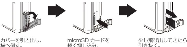
※ 挿入する時は逆の手順で行なってください。また必ず液晶側に microSD カードの口ゴが見えるように挿入してください。逆向きに無理矢理挿入すると破損します。
