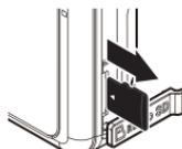
少し飛び出してきたら引き抜く。
