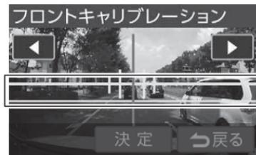
道路の水平線が、上下の黄色の横線内に収まる様に調整する。
