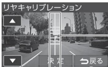
道路の中央が、黄色の縦線にあわせるように調整する。
