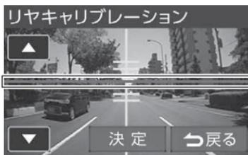
赤線が道路の水平線にあわせるように調整する。
