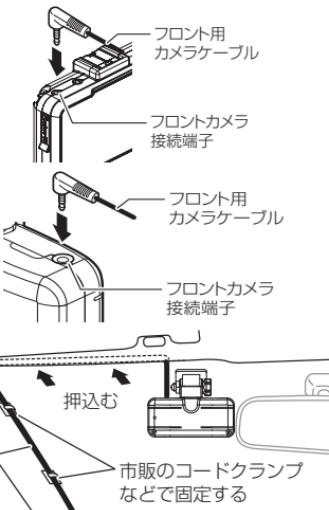
5) フロントカメラのフロントカメラ接続端子に、フロント用カメラケーブルを「カチッ」と音がなるまで押し込み接続します。
