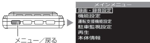
2. 【アップ】を2回押し【再生】を選択して【OK】を押す。
