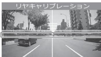
赤線が道路の水平線に合うように調整する。
