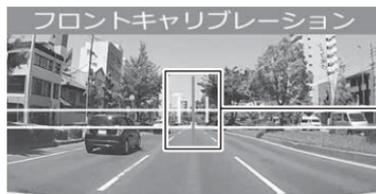
赤色の縦線が車線の中心に合うように【アップ】【ダウン】やフロントカメラの向きで調整する。
