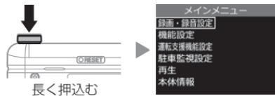
2. スイッチを【▼】方向へ4回押し [再生]を選択してスイッチを短く押込む。
