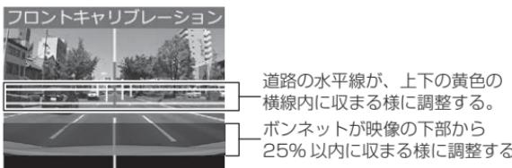
2. フロントカメラの向きの調整（⇒ P16）および【▲】【▼】スイッチを操作し、赤色の縦線が車線の中心に合うように左右方向の調整を行います。
