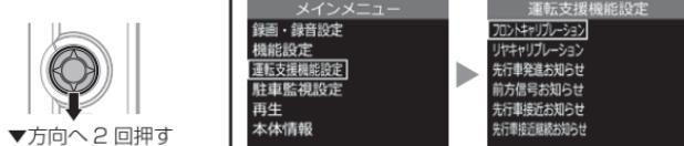
3. [フロントキャリブレーション] または [リヤキャリブレーション] を【▲】または【▼】で選択してスイッチを短く押込む。
