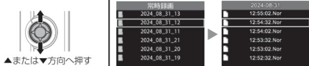
5. 再生するファイルを【▲】または【▼】で選択してスイッチを短く押込むと映像の再生が始まります。
