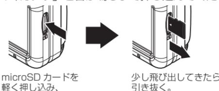
※ 插入する時は逆の手順で行なってください。また必ず液晶側に microSD カードのロゴが見えるように挿入してください。逆向きに無理矢理挿入すると破損します。
