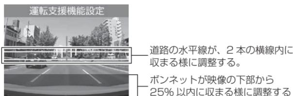
2. 本体の向きの調整（⇒ P16）および【アップ】【ダウン】スイッチを操作し、赤色の縦線が車線の中心に合うように左右方向の調整を行います。
