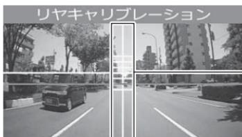
2. 【アップ】【ダウン】スイッチを操作し、赤色の横線が道路の水平線に合うように調整を行います。
