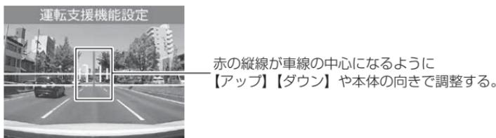
赤の縦線が車線の中心になるように【アップ】【ダウン】や本体の向きで調整する。
