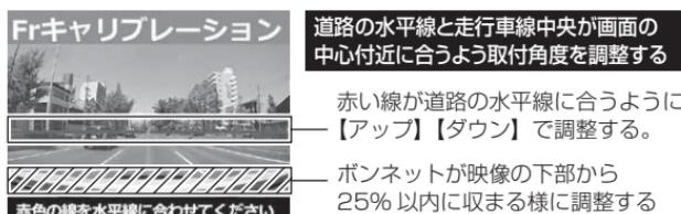
2. 次に青色の横線が車の先端に合うように【アップ】【ダウン】スイッチを操作し、調整を行なったら【OK】を押す。
