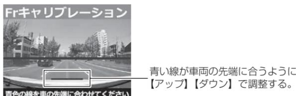
車両の先端が映らない場合は、前方約3m先の路面に合わせて青色線を調整してください。
