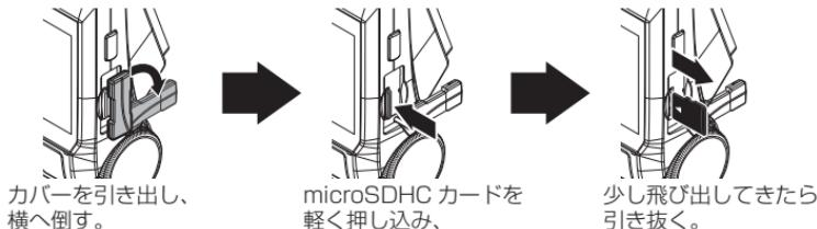
※ 挿入する時は逆の手順で行なってください。また必ず液晶側に microSDHC カードのロゴが見えるように挿入してください。逆向きに無理矢理挿入すると破損します。
