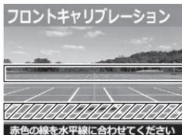
道路の水平線と走行車線中央が画面の中心付近に合うよう取付角度を調整する
