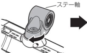
ステー軸の向きを  $180^{\circ}$  回転させる
