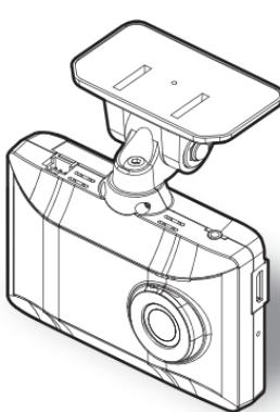
お買い上げ時の設定では、液晶ディスプレイは安全運転の妨げとならないように、起動後速度10km/h以上で走行すると非表示に切替わります。(⇒P72)
