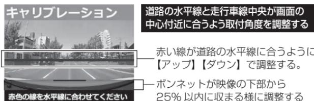
5. 次に青色の横線が車の先端に合うように【アップ】【ダウン】スイッチを操作し、調整を行なったら【OK】を押す
