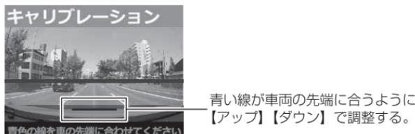
車両の先端が映らない場合は、前方約 3m 先の路面に合わせて青色線を調整してください。
