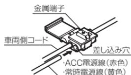
2) プライヤー等で金属端子を完全に押し込みます。
