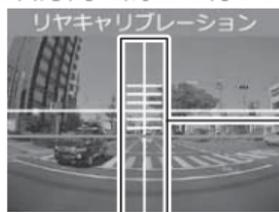
道路の中央が、黄色の縦線に合うように調整する。
