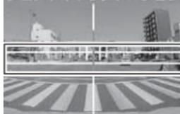
道路の水平線が、上下の黄色の横線内に収まるように調整する。
