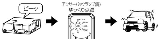
\*メインユニットがリモコンからの電波を受信できなかった場合は、リモコンのアンサーバックランプ (青) は点滅しません。（アンサーバック音をメロディまたは、ブザーに選択されている場合は NG 音が鳴ります）
