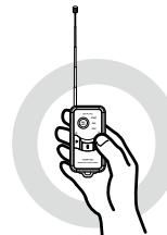
●アンテナを伸ばさずに操作すると電波の受信距離が短くなります。
