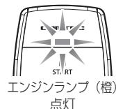
※一部車両でエンジン始動時の電気ノイズや場所によっては、周囲の電波の影響を受けて、エンジンランプ（橙）が点灯（アンサーバック）しないことがあります。
