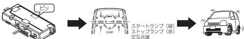
\* アンテナユニットがリモコンからの電波を受信できなかった場合は、リモコンのスタートランプ（緑）とストップランプ（赤）は交互点滅しません。（アンサーバック音をメロディまたは、ブザーに選択されている場合はNG音が鳴ります）
