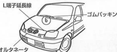
**3** 車のL端子線とL端子延長線（白）を付属の工具エレクトロタップで接続します。
