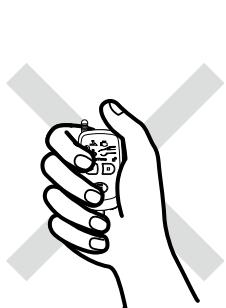
●アンテナを伸さずに操作すると電波の受信距離が短くなります。
