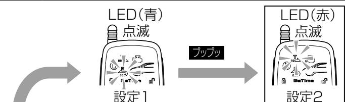
設定 1…リモコンのスタートスイッチ (▶) 2度押し (セキュリティ威嚇 LED スタート) すると WARNING ランプが点滅、リモコンのストップスイッチ (■) 2度押し (セキュリティ威嚇 LED ストップ) すると消灯します。(セキュリティモード運動)
