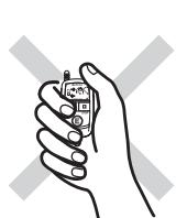
●アンテナを伸さずに操作すると電波の受信距離が短くなります。
