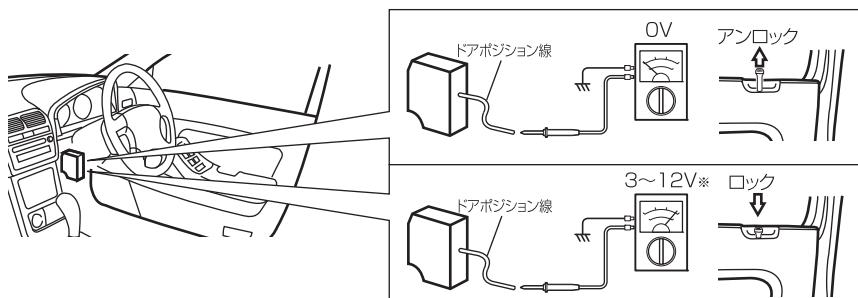
ドアロックノブを操作してロック時に3~12V\*、アンロック時に0Vになる線を探します。
