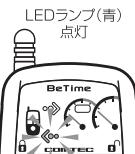
※アンテナユニットがリモコンからの電波を受信できなかった場合は、リモコンのLEDランプ(青)は点灯しません。(アンサーバック音をメロディ又は、ブザーに選択した場合は、NG音が鳴ります。)
