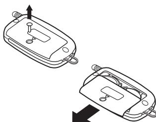
2.下図の溝に細い棒等を入れ、古い電池を取り出し、新しい電池(CR2025×2個)をリモコンのアンテナ側はーを上に、キーリング側は+を上にしてセットします。
