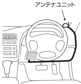
②アンテナコードの端子をメインユニットのアンテナコネクターに差込みます。
