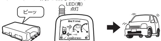
\* アンテナユニットがリモコンからの電波を受信できなかった場合は、リモコンのLEDランプ(青)は点灯しません。(アンサーバック音をメロディ又は、ブザーに選択した場合はNG音が鳴ります。)
