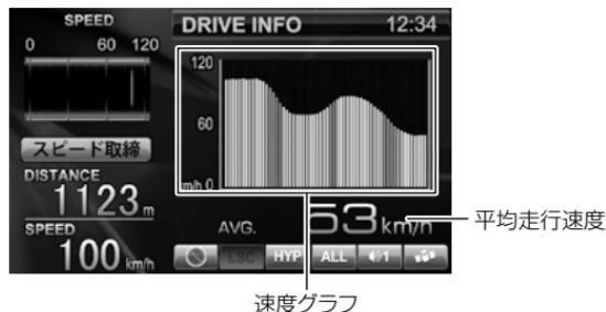
◇グラフの色は速度変化・加速度変化の大きさを表わしています。
