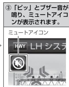
**リモコン** 各種警報中に【ミュート】を短押しする
