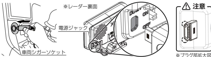
※ 電源ジャックおよびプラグには向きがあるため、無理に差し込むと破損します
