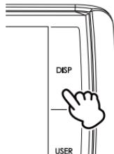
2. 液晶表示の ON/OFF が切替わります
