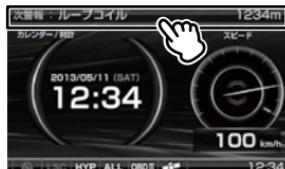
2. 表示画面をタッチすることで公開取締情報（ホーム）→公開取締情報（ドライブ）→公開取締情報（検知）→マップコード→緯度経度→公開取締情報（ホーム）の順に表示が切替わります。
