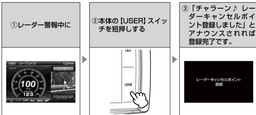
**リモコン** レーダー警報中に **【レーダーキャンセル】** を長押しする
