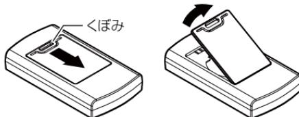
2. 古い電池を矢印の方向にスライドさせ取外します
