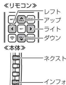
時計 ⇄ 速度 ⇄ 進行方向 ⇄ 運転時間 ⇄ 標高 ⇄ 車両電圧 ⇄ GPS 情報 ⇄ 走行距離
