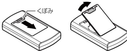
2. 古い電池を矢印の方向にスライドさせ取外します
