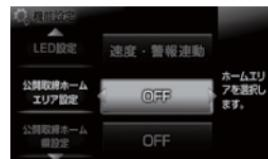
3. 【ダウンスイッチ】で [ 公開取締ホーム県設定 ] または [ 公開取締ドライブ県設定 ] を表示させる
