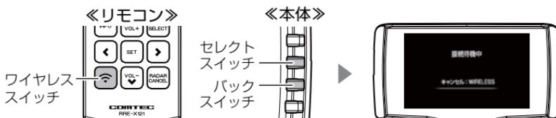
4. スマートフォンの『Wi-Fi 設定』から接続先を『COMTEC-RADAR』にする
