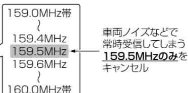
※キャンセルした159.5MHz以外の159.0～159.4MHz、159.6～160MHzを受信するとキャンセルされずに警報を行います。
