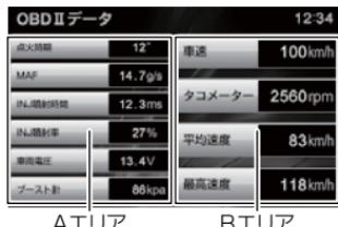
待機画面壁紙設定を OBD II データに設定時、車両 OBD II コネクターより得られる情報を一覧で表示します。
