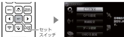
2. 【アップスイッチ】【ダウンスイッチ】を押して、メニュー項目を選択し、【セットスイッチ】を押して決定する
