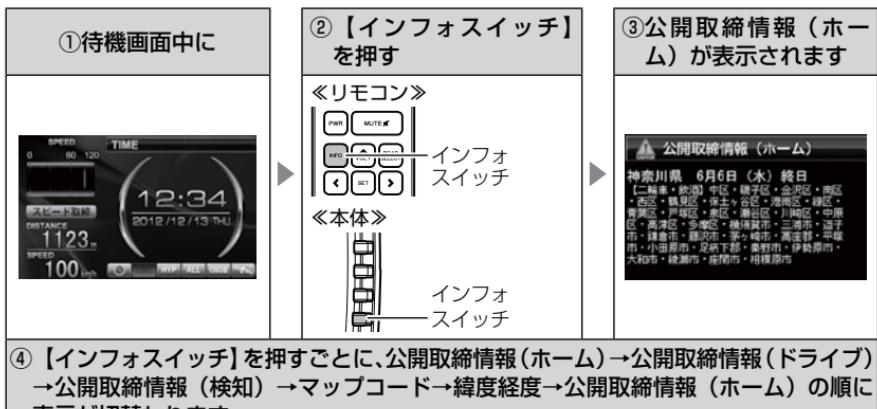
④【インフォスイッチ】を押すごとに、公開取締情報（ホーム）→公開取締情報（ドライブ）→公開取締情報（検知）→マップコード→緯度経度→公開取締情報（ホーム）の順に表示が切替わります。
