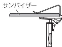
サンバイザーにディスプレイを取り付け固定する
