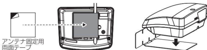
4. レーザー受信部が進行方向を向くようにアンテナを固定します。振動で落下しないようにしっかり固定してください。
