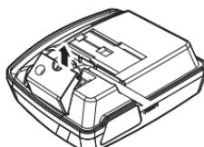
3. 接続ケーブルを図の向きに引き抜きます。
