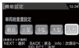
2. 【ネクストスイッチ】で数字を選択、【セットスイッチ】で決定を繰り返し、車両総重量を入力し、【ネクストスイッチ】で【登録】を選択、【セットスイッチ】で決定します。
