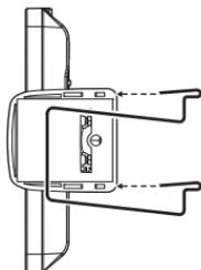
サンバイザークリップをステアのサンバイザークリップ取付穴に差し込む
