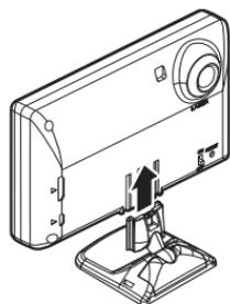
3. 濡れたタオルなどでダッシュボードを拭き、きれいにしてから固定します。下図①、②、③のようにレーダー本体が垂直で車両の進行方向を向くように調整します。
