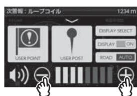
リモコンで音量を変更するには、待機画面表示中に / を短押しすることで直接音量を変更することができます。
