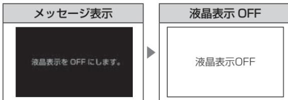
※液晶画面をタッチして一時的に(約15秒間)画面表示されている間に再度同様の操作を行うと、メッセージ表示後に液晶表示がONになります。
