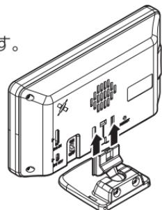
3. 濡れたタオルなどでダッシュボードを拭き、きれいにしてから固定します。下図Ⓐ、Ⓑ、Ⓒのようにレーダー本体が垂直で車両の進行方向を向くように調整します。
