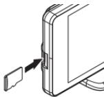
microSDHCカードの端子部が本体背面を向くように挿入し、「カチッ」と音が鳴るまで軽く押し込んでください。
