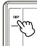
2. 液晶表示の ON/OFF が切替わります。
