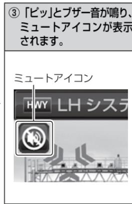
**リモコン** 各種警報中に【ミュート】を短押しする
