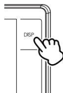
2. 液晶表示の ON/OFF が切替わります。
