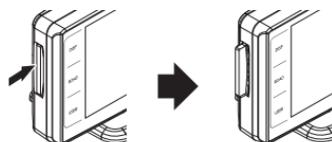
SDカードを軽く押し込み、少し飛び出してきたら引き抜いてください。
