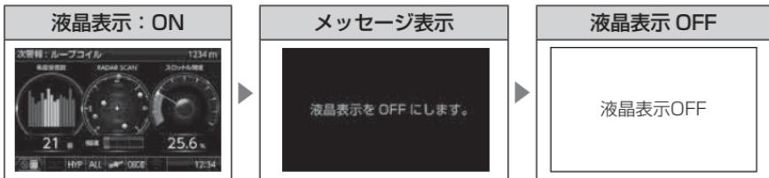
※再度【DISP】スイッチを長押しすると、メッセージ表示後に液晶表示が ON になります。
