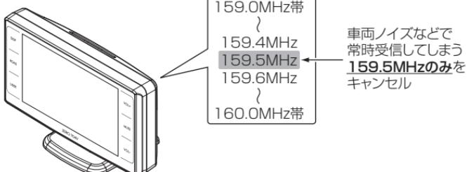
※キャンセルした159.5MHz以外の159.0～159.4MHz、159.6～160MHzを受信するとキャンセルされずに警報を行います。
