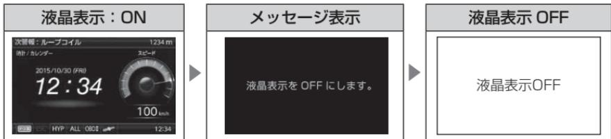
※再度【DISP】スイッチを**長押し**すると、メッセージ表示後に液晶表示が ON になります。
