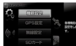
2. 【アップスイッチ】【ダウンスイッチ】を押して、メニュー項目を選択し、【セットスイッチ】を押して決定する
