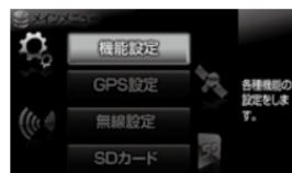
4. 【アップスイッチ】【ダウンスイッチ】で [SD カード] を選択し、【セットスイッチ】を押す
