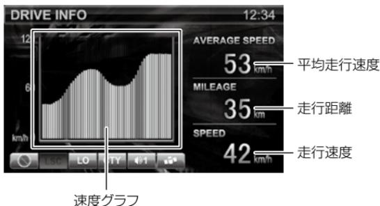
◇グラフの色は速度変化・加速度変化の大きさを表わしています。
