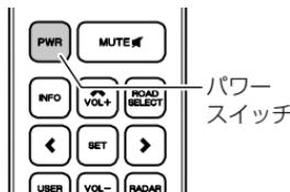
2. 液晶表示の ON・OFF が切替わります
