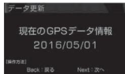
3. 確認画面で【ネクストスイッチ】を短押ししてデータ更新を開始します。
