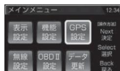
2. 【セレクトスイッチ】で【GPS設定】を選択し、【ネクストスイッチ】で決定します。
