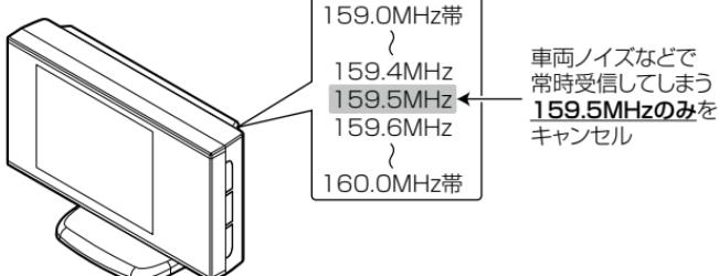
※キャンセルした159.5MHz以外の159.0～159.4MHz、159.6～160MHzを受信するとキャンセルされずに警報を行います。
