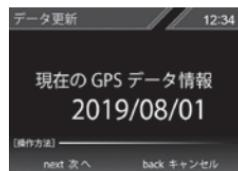
3. 確認画面で【ネクストスイッチ】を短押ししてデータ更新を開始します。
