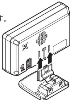
**3.** 濡れたタオルなどでダッシュボードを拭き、きれいにしてから固定します。下図Ⓐ、Ⓑ、Ⓒのようにレーダー本体が垂直で車両の進行方向を向くように調整します。
