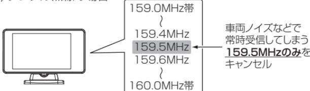
※キャンセルした159.5MHz以外の159.0～159.4MHz、159.6～160MHzを受信するとキャンセルされずに警報を行います。
