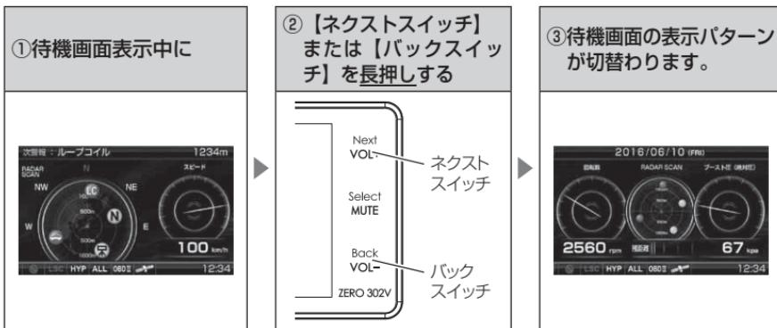
※ 表示項目を切替える場合は、【セレクトスイッチ】を短押しし、表示項目変更モードより変更を行なってください。(⇒ P29)
