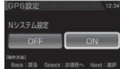
3. 【セレクトスイッチ】で【Nシステム設定】を選択し、【ネクストスイッチ】で【OFF】を選択します。
