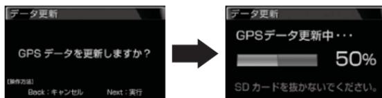
5. 更新が完了すると、自動的に再起動します。レーダー本体が正常に起動したらデータ更新は完了です。
