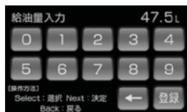
8. 確認画面で【ネクストスイッチ】を短押しし、満タン補正を実行します。
