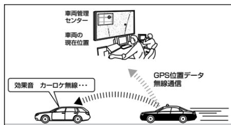
現在、緊急車両の多くはGPSより算出した位置データを無線で定期的(間欠)に各本部へ送信するカーロケーターシステムを装備しています。
