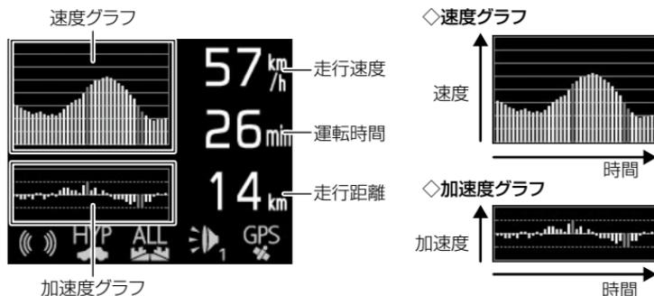
◇グラフの色は速度変化・加速度変化の大きさを表わしています。
