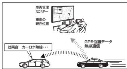
現在、緊急車両の多くはGPSより算出した位置データを無線で定期的（間欠）に各本部へ送信するカーロケターシステムを装備しています。
