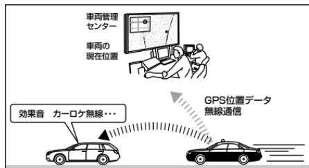
現在、緊急車両の多くはGPSより算出した位置データを無線で定期的(間欠)に各本部に送信するカーロケーター・システムを装備しています。
