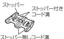
2) スッパー付きコード溝に電源コードの ACC 線を挟み、ペンチ等でロックする
