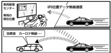
現在、緊急車両の多くはGPSより算出した位置データを無線で定期的(間欠)に各本部に送信するカー・ロケーター・システムを装備しています。
